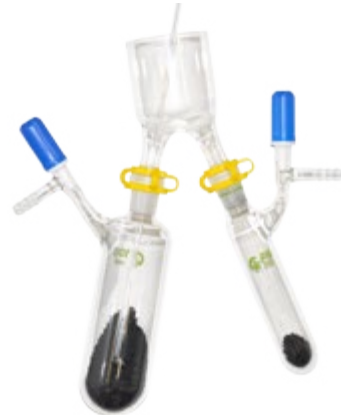
Abb. 7 Überführung mit einem Glasspatel, geschützt vor Luftströmungen (wenn erforderlich, kann Inertgas – bevorzugt Ar – benutzt werden, um das Pulver gegen Feuchtigkeit und Luft zu schützen)
