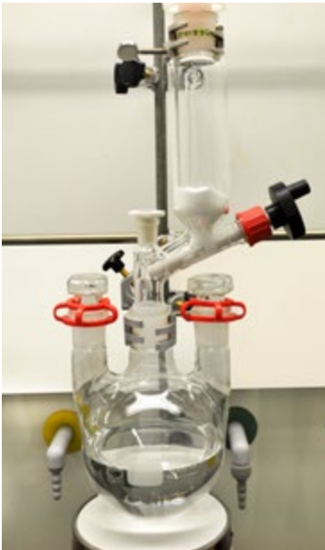
Abb. 8 Handbetätigter Pulverdosiertrichter auf einem Dreihalskolben
