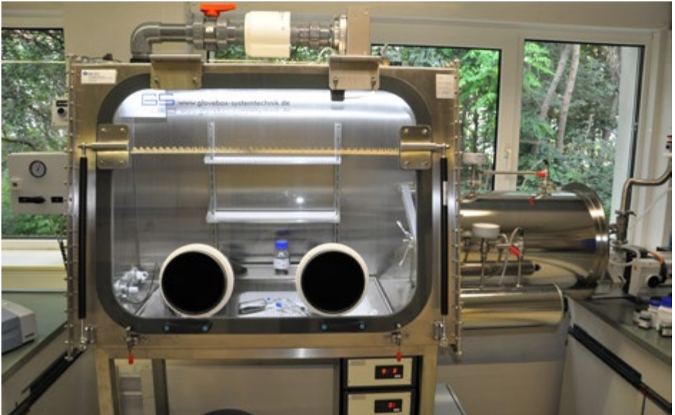
Abb. 13 Glovebox mit Schleusensystem
