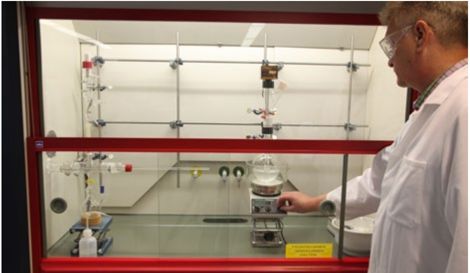
Abb. 3 Abzug mit Arbeiten durch Frontschieber
