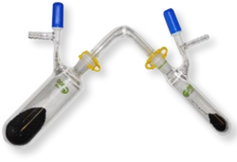
Abb. 6 Transferbogen für Pulver, geschützt vor Luftströmungen (wenn erforderlich, kann Inertgas – bevorzugt Ar – benutzt werden, um das Pulver gegen Feuchtigkeit und Luft zu schützen)
