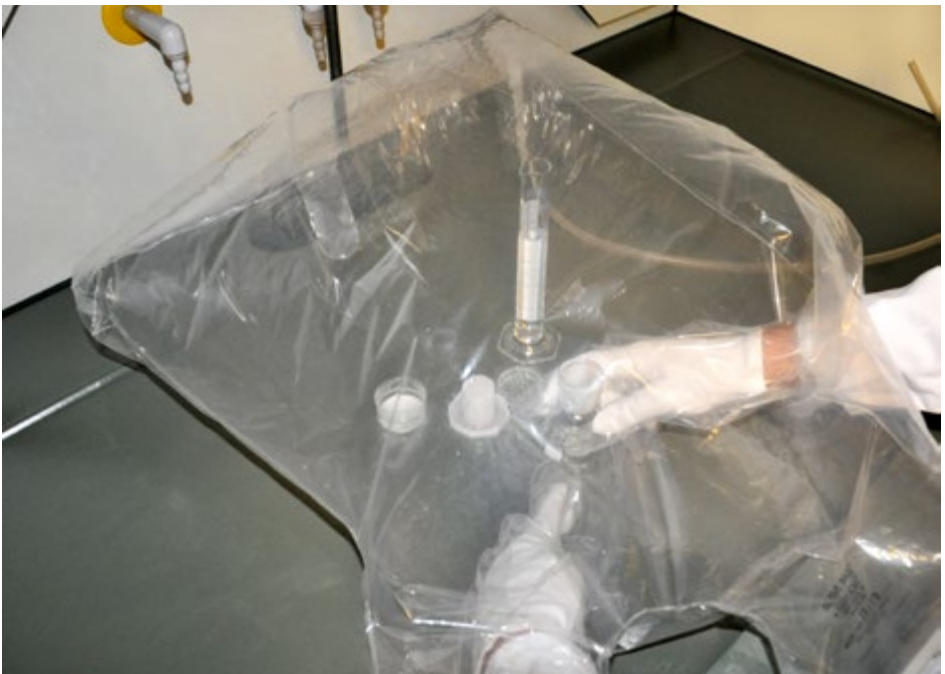
Abb. 14 Glovebag mit Verschlussclip der Beschickungsöffnung
