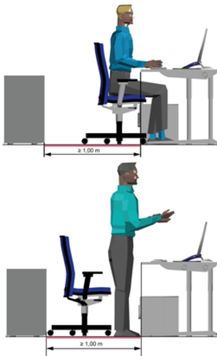
Abb. 2: Mindesttiefe der Bewegungsfläche im Sitzen und Stehen (Quelle: VBG Hamburg [ www.vbg.de ])
