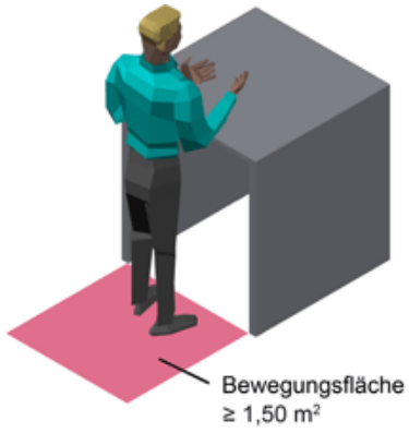
Abb. 1: Mindestgröße der Bewegungsfläche im Sitzen und Stehen (Quelle: VBG Hamburg [ www.vbg.de ])
