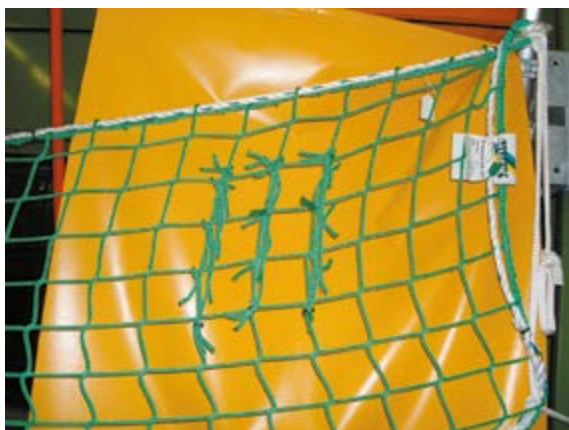
Abb. 4-12 Prüffäden und Kennzeichnung
