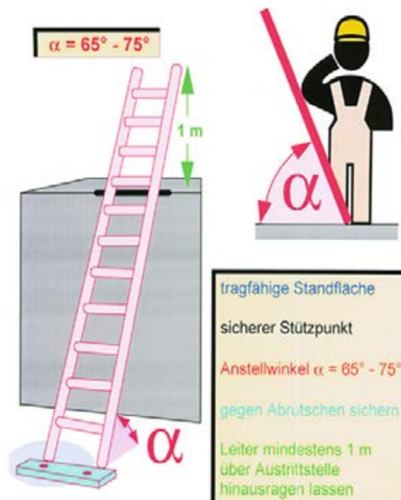
Abb. 4-2 Sichere Aufstellung einer Anlegeleiter
