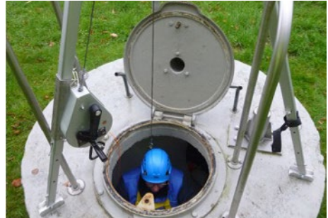
Abb. 23 Höhensicherungsgerät mit Rettungshubfunktion
