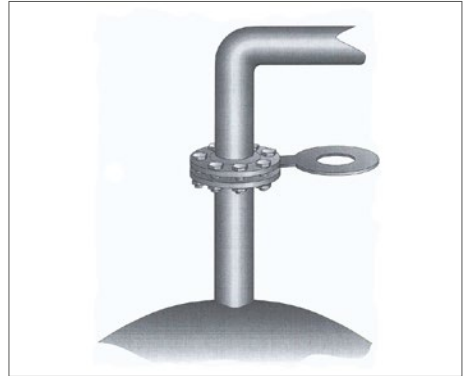
Abb. 18 Abtrennen mittels Steckscheibe
