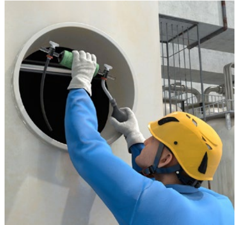
Abb. 20 Probenahme mittels Gassammelrohr
