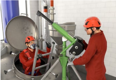
Abb. 22 Rettungswinde, hier als Schutz gegen Absturz eingesetzt
