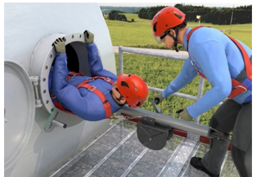
Abb. 26 Seiteneinstieg mittels spezieller Halterung des Rettungshubgerätes
