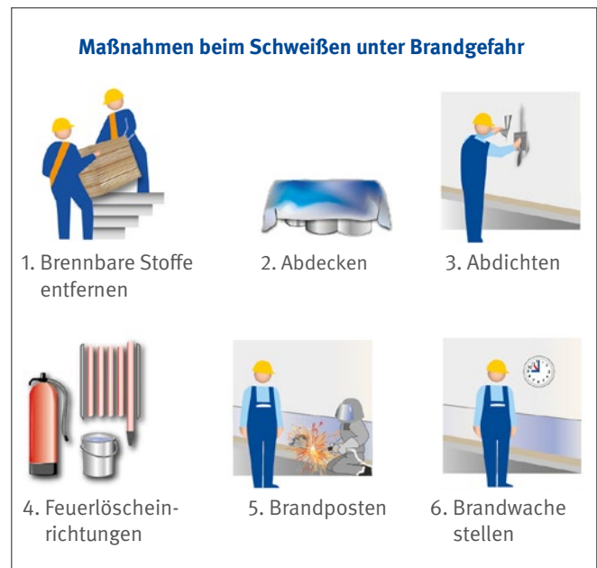
Abb. 15 Maßnahmen beim Schweißen unter Brandgefahr
