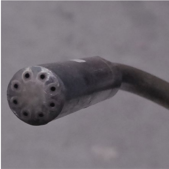
Abb. 8 Geräuscharmer Wärmebrenner mit Mehrlochdüse
