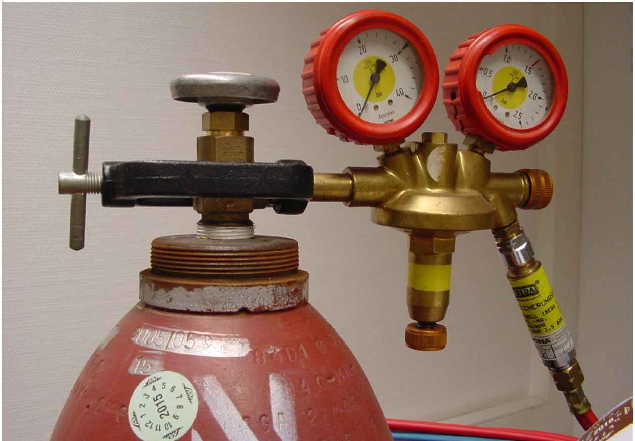
Abb. 9 Acetylenflasche mit Druckregler, Sicherheitsmanometern und Sicherheitseinrichtung mit Flammensperre, Gasrücktrittsicherung und Nachströmsperre
