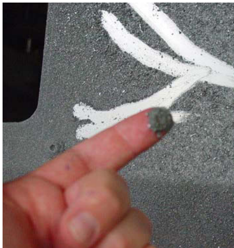
Bild 34 Verklebungen im Maschineninnenraum
