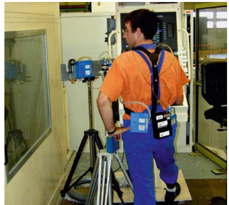
Bild 41 Expositionsmessungen stationär sowie personengetragen am Bedienpult
