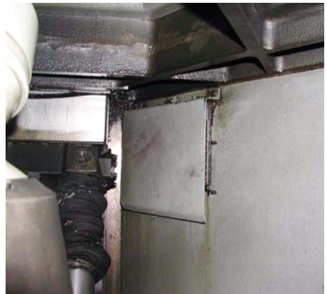
Bild 30 Prallblech über Absaugstelle
