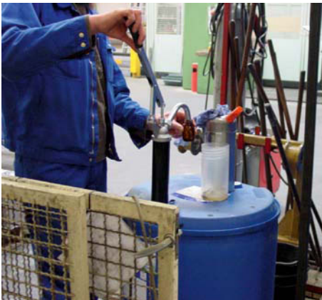
Bild 2 „Schmierstoffzentrallager“ bei Minimalmengenschmierung
