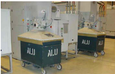
Bild 50 Abgedeckte und gekennzeichnete Alu-Spänebehälter
