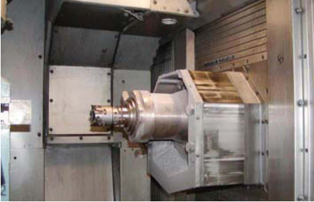
Bild 23 Nutzung der Schwerkraft zur Späneabfuhr, steile Bleche
