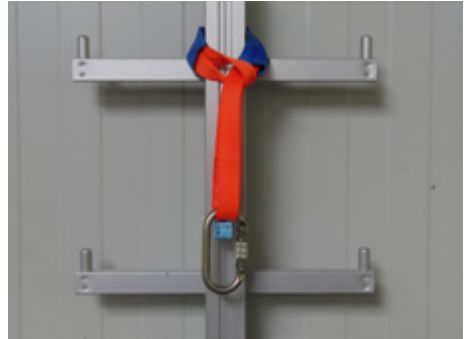
Abb. 22 Anschlagen an einer Steigleiter mit Mittelholm durch Umschlingen der Schiene über einer Leitersprosse
