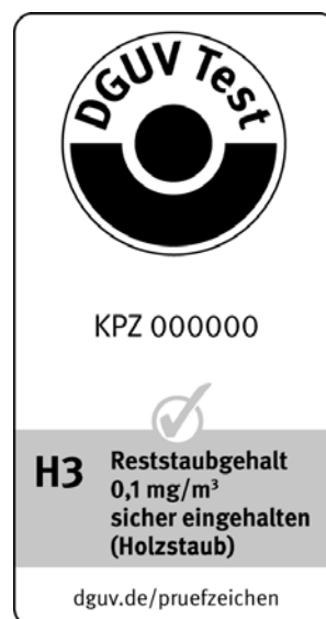
Abb. 13 DGVU Test-Zeichen H3 (für Holzstaub-Absauganlagen und -Entstauber)
