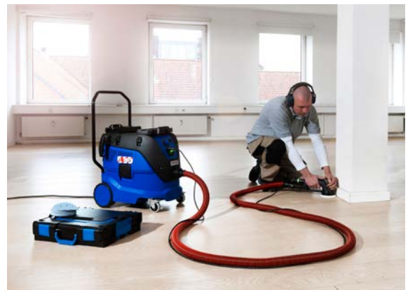
Abb. 10 Absaugung eines handgeführten Elektrowerkzeugs
