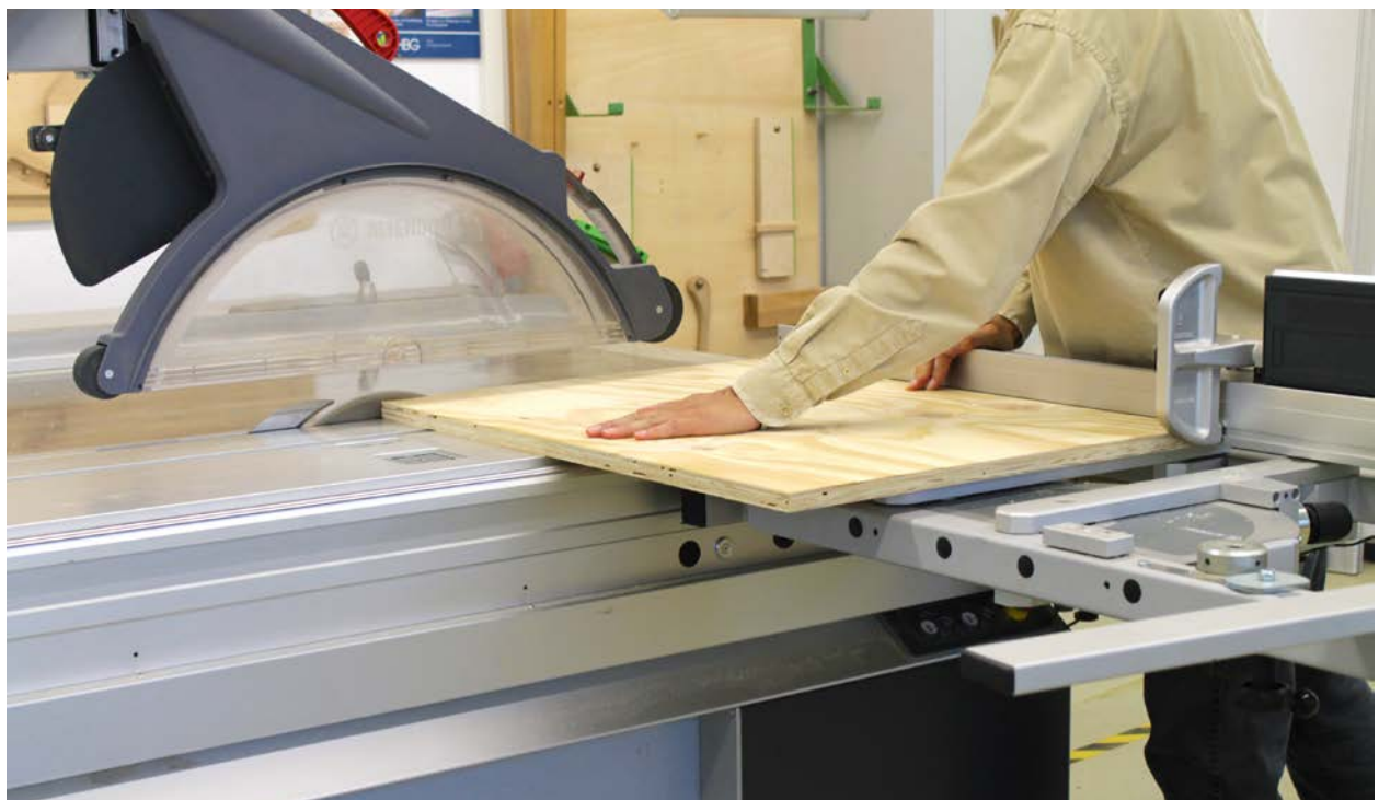
Abb. 8 Absaugung an der Entstehungsstelle
