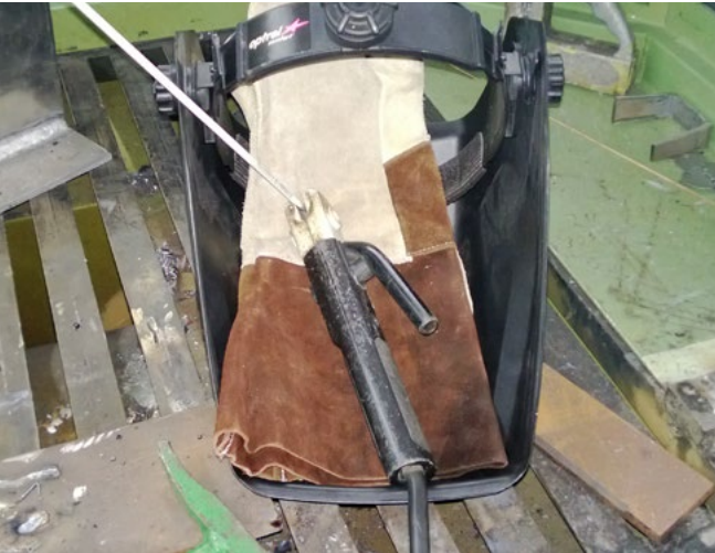
Abb. 6-4 Stabelektrodenhalter immer isoliert ablegen
