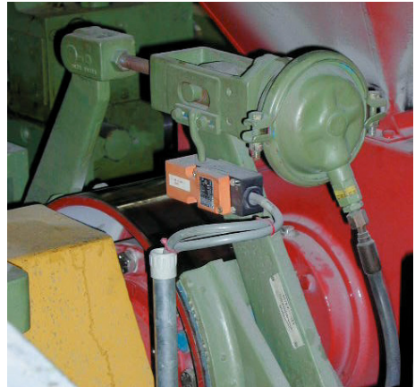
Abb. 1 Diese Bremse ist als Feststellbremse ausgelegt. Versuche haben ergeben, dass sie keinen Schaden nimmt, wenn sie zusätzlich zur Betriebsbremse bei etwa 20 m/min oder weniger durch einen Not-Halt-Befehl aktiviert wird, wodurch sich der Nachlauf zum Teil drastisch verkürzen lässt.
