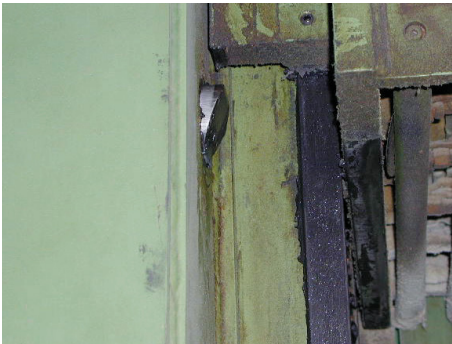
Abb. 5 Die Andruckwalze ist in oberer Endstellung. Ein ausgefahrener Bolzen auf jeder Maschinenseite hält sie bei Ausfall des Tragmittels in oberer Stellung.
