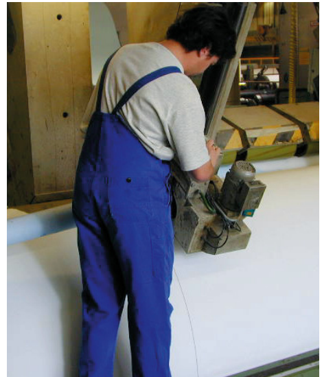
Abb. 7 Der Bediener spannt eine neue Hülse ein. Während er mit der linken Hand die Hülse führt, fährt er mit der rechten die Spannkone mit Tippbetrieb ein.
