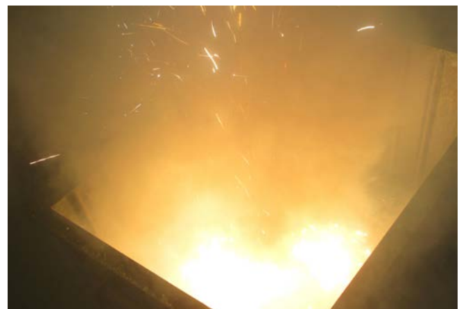
Abb. 4 Brennendes Magnesium im Spänebehälter
