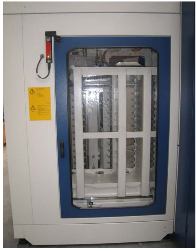
Abb. 12 Türsicherheitsschalter/Positionsschalter mit Notenspernung an Schutztür Magazinwartung
