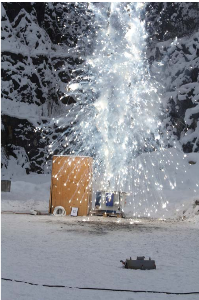
Abb. 14 Schmelzeauswurf bei eingebrachtem Wasser, ca 50 ml
