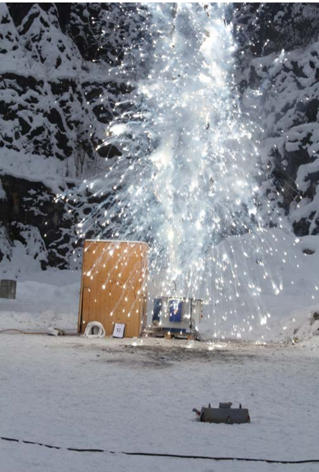
Abb. 3 Thermolysereaktion von eingebrachtem Wasser (ca. 50 ml) in Magnesiumschmelze
