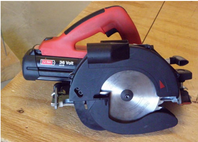
Abb. 18 Mit Lithium-Ionen-Akkus betriebene Akkuhandkreissäge
