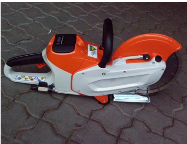
Abb. 19 Mit Lithium-Ionen-Akkus betriebene Trennschleifmaschine
