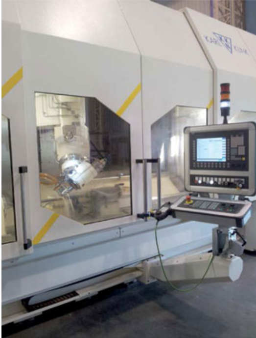
Bild 8-4: CNC-Schleifmaschine mit Vollverkleidung des Bearbeitungsraumes
