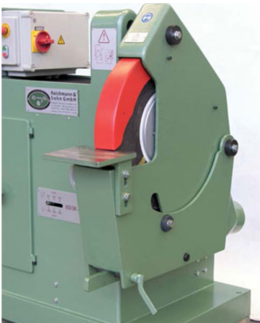
Bild 8-3: Schutzhaube mit Rot-Visier an einer Ständerschleifmaschine für das Umfangschleifen mit v_s > 50 m/s
