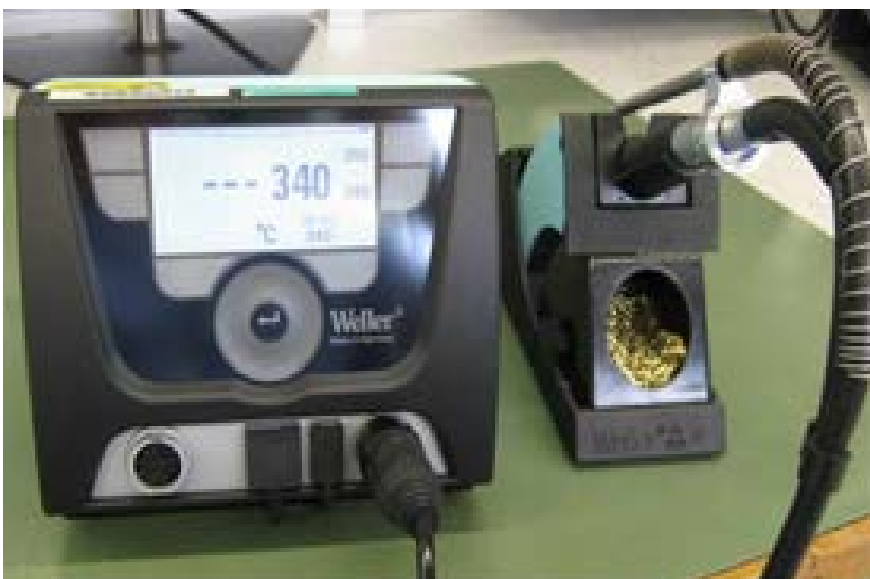
Abbildung 2 Bleifreies Kolbenlöten mit Lötspitze, Lötendraht und Absaugung
