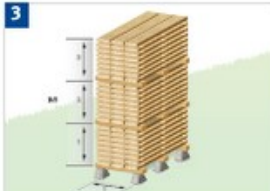
Einzel stehende Pakete unbesäumter Ware zum Trocknen im Freien. Die Lagen sind nicht voll ausgefüllt, deshalb darf das Verhältnis Höhe zu Breite max. 3:1 sein.
