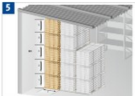
Bei Stapeln in der Halle oder im Windschatten an der Außenwand der Halle Höhe zu Breite max. 5:1.
