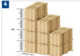
Im Freien nebeneinandergesetzte Schnittholz-Kastenstapel-Pakete mit voll ausgefüllten Lagen, bei besäumter Ware, Verhältnis Höhe zu Breite max. 4:1, max. 5 m hoch.
