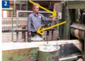
Störungsbeseitigung am Spaltkeil, Auszugswalzen mit Griff
