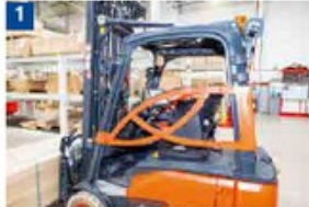
1 Fahrrückhalteeinrichtung (hier: Bügel) bei jeder Fahrt benutzen.
