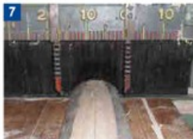
Eine leichtgängige Rückschlagsicherung umschließt das Werkstück lückenlos und verhindert das Heraus-schleudern von Splittern.
