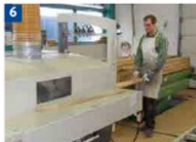
Beim Aufgeben an der Mehrblattsäge Schürze als Rumpfschutz tragen.
