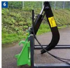
Gabelstapler mit Zangengreifer zum Transport von Rundholz
