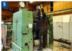
Spannen der Sägeblätter von geeigneter Standfläche aus
