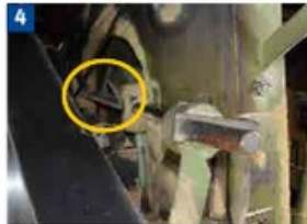
Formschlüssige Sicherung gegen Herabsinken des Sägerahmens
