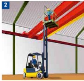
Instandhaltungsarbeiten mit Gabelstapler und Arbeitsbühne
