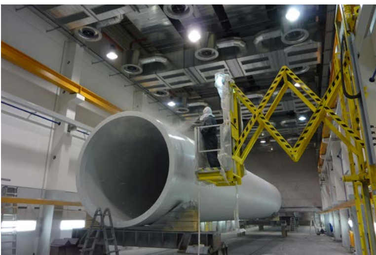
Abb. 31 Lackieren eines großen Werkstücks in einer Lackierkabine mit Absaugung
