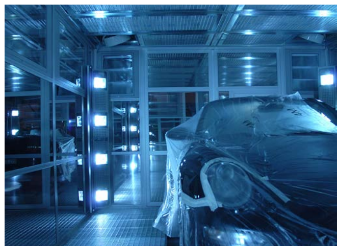
Abb. 26 Kombikabine in Spezialausführung mit UV-Strahlern
