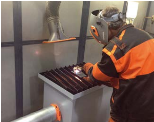
Abb. 4-2 Brennschneiden in der Atmosphäre mit Erfassung der Gase an der Entstehungsstelle und mit Untertischabsaugung der Schweißrauche
