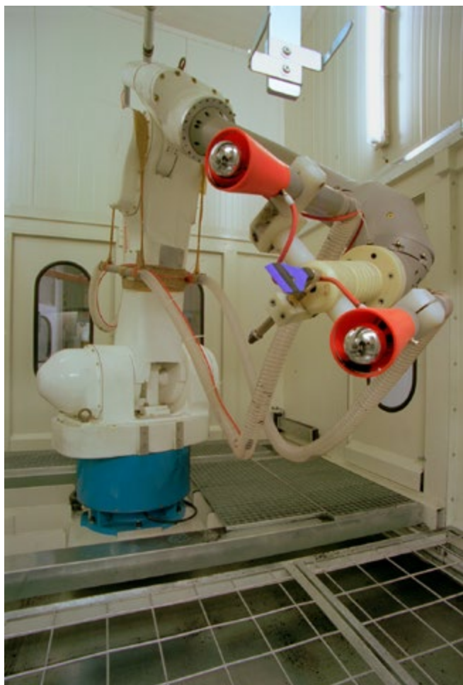
Abb. A10-15 Robotergeführte Beflockungsanlage mit luftzerstäubenden Sprühsystemen
