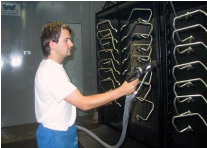
Abb. A10-1 Manuelles Beschichten von Automobilteilen mit luftzerstäubender Handsprüheinrichtung
