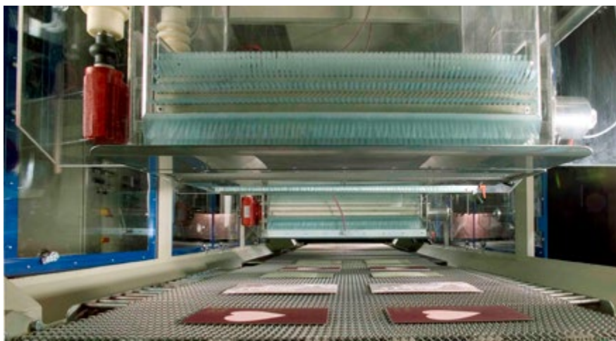
Abb. A10-13 Sprühsystem in einer automatischen Flächenbeflockungsanlage zur Beschichtung von Textilien
