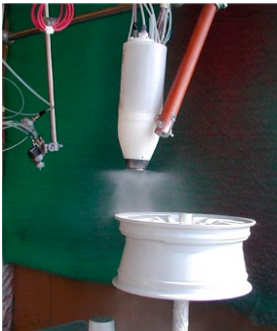
Abb. A10-4 Hochrotations-Sprühsystem zur Beschichtung von Pkw-Aluminiumrädern für Decklack
