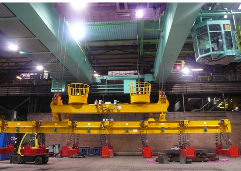
Abb. 12 Magnettraversenkran für den Blechtransport
