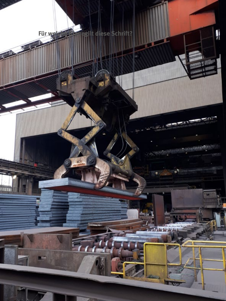
Abb. 5 Brammentransportkran mit Zange
