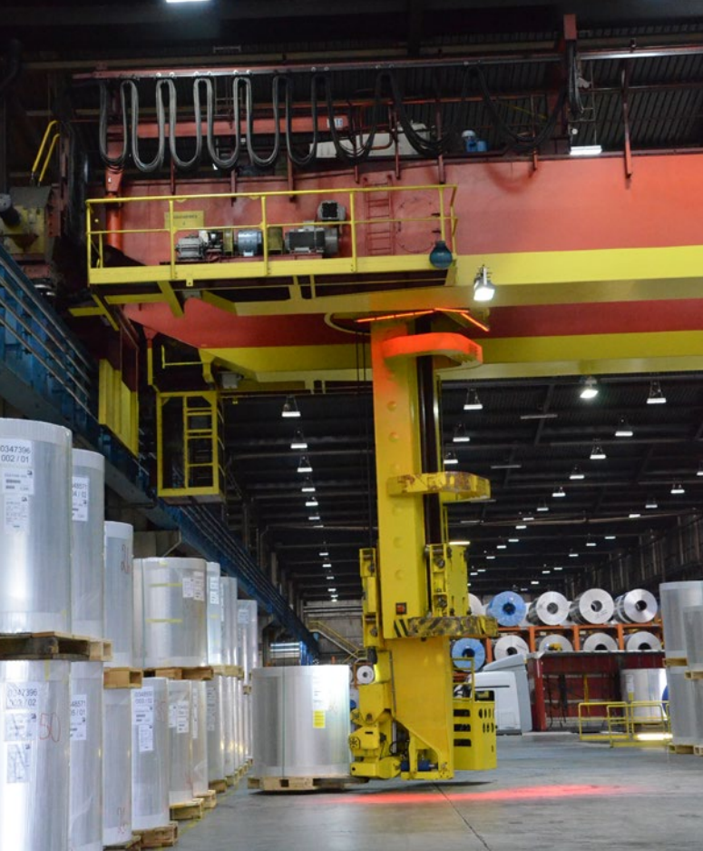
Abb. 10 Regalbedienkran mit starrer Lastführung, nicht teleskopierbar
