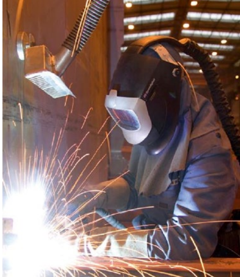
Abb. 8 Schweißrauchabsaugung plus Schweißerschutzhaube mit Frischluftversorgung (persönliche Schutzausrüstung)
