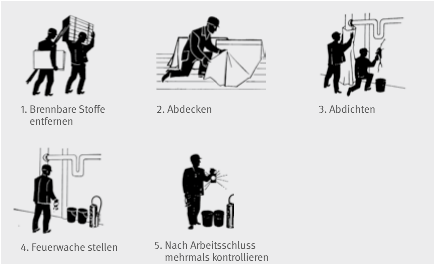
Abb. 8-3 Maßnahmen beim Schweißen unter Brandgefahr
