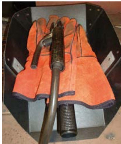
Abb. 4-2 Ohne Elektrodenrest isoliert abgelegter Stabelektrodenhalter
