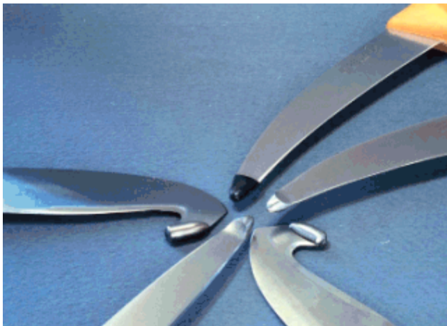
Abb. 12: Gekrösemesser; der Verzicht auf die Spitze schont das Material und verhindert Stichverletzungen
