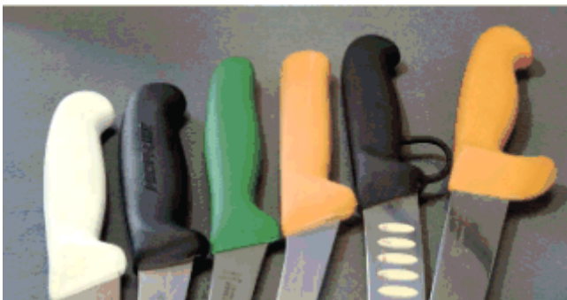
Abb. 16: Verschiedene Griffotypen verhindern Abrutschen auf die Schneide
