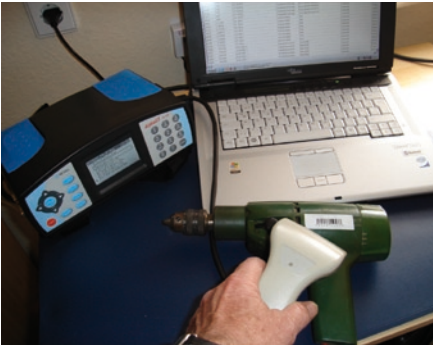
Bild 3: Rechnergestützter Prüfplatz mit Barcode-Scanner
