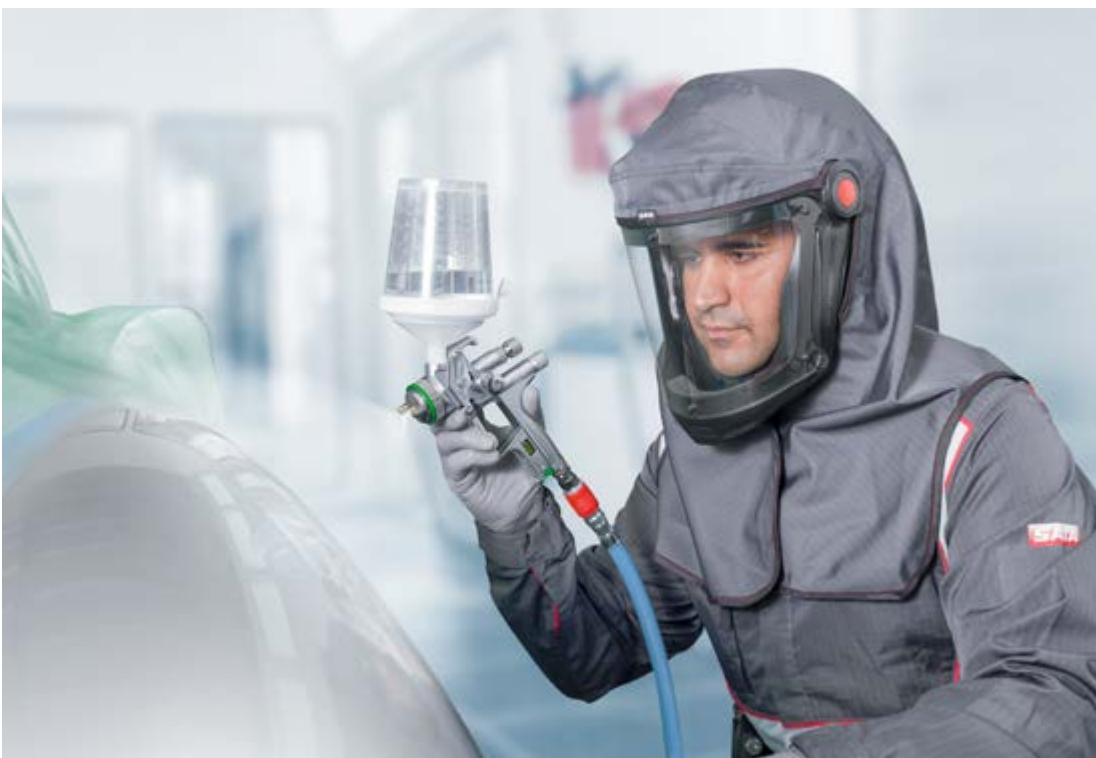
Abb. 2 Spritzlackieren mit HVLP-Pistole
