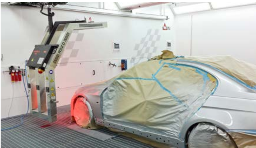
Abb. 6 Kraftbetriebenes, schienengeführtes IR-Trocknungsgerät
