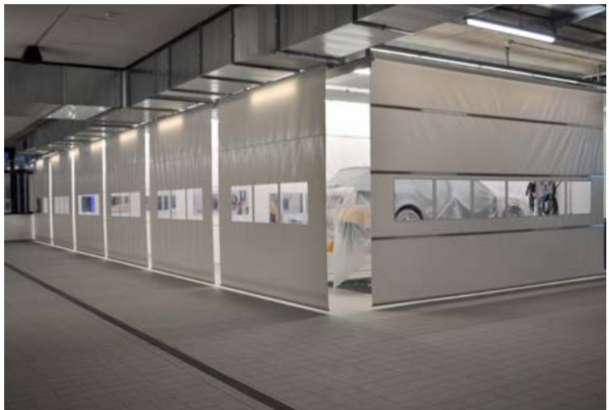
Abb. 4 Vorbereitungsplatz mit geschlossenen Abtrennungen
