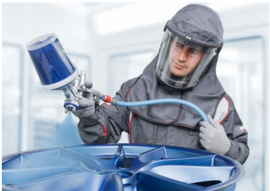
Abb. 14 Spritzlackieren mit Atemschutzgerät
