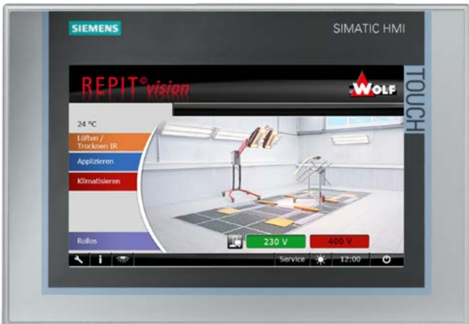
Abb. 7 Beispiel Bedienfeld der Steuerung für einen Vorbereitungsplatz
