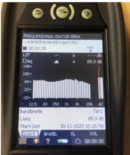
Abb. 22 Terz-Frequenzanalyse mit der Software des Messgeräts
