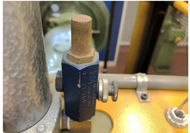
Abb. 26 Sintermetall-Schalldämpfer an pneumatischer Steuerung
