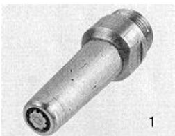
Bild 2 Untersuchte geräuschgeminderte Düsen/Blaspistolen
