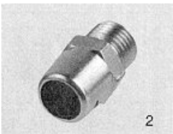
Bild 2 Untersuchte geräuschgeminderte Düsen/Blaspistolen
