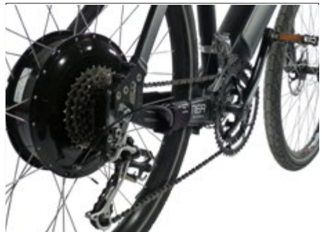
Abb. 6 Nabenmotor im Hinterrad
