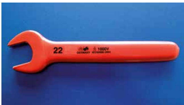
Bild 5-6: Vollisolierter Einmalschlüssel für Arbeiten bis 1000 V
