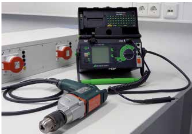
Bild 5-35: Prüfgerät für die Prüfung ortsveränderlicher elektrischer Betriebsmittel
