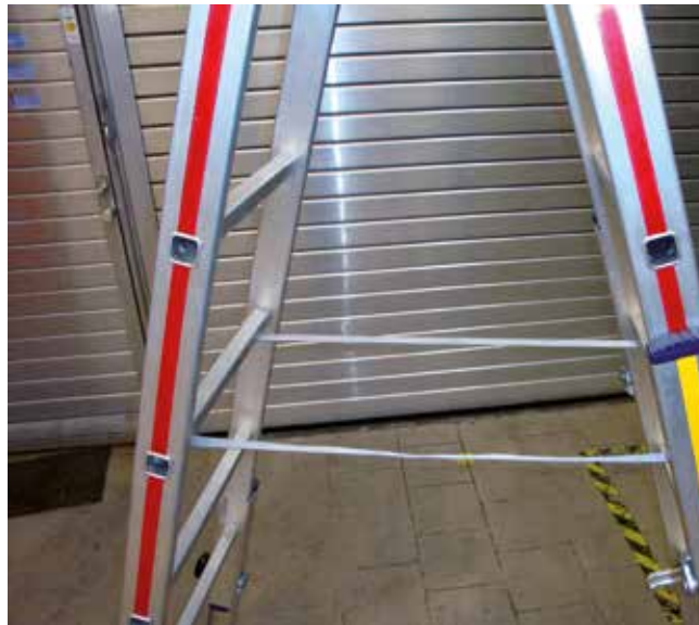
Bild 6-1: Fest angebrachte und fest sitzende Spreizsicherung und verstellbare Länge der Leiterfüße, um Unebenheiten der Standfläche ausgleichen zu können
