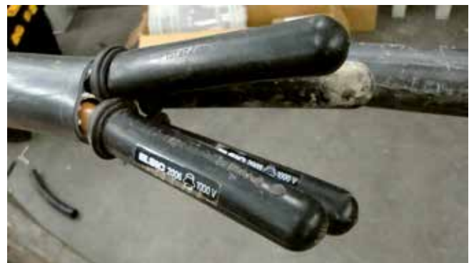
Bild 5-5: Isolierkappen zum Abdecken von Isolatoren
