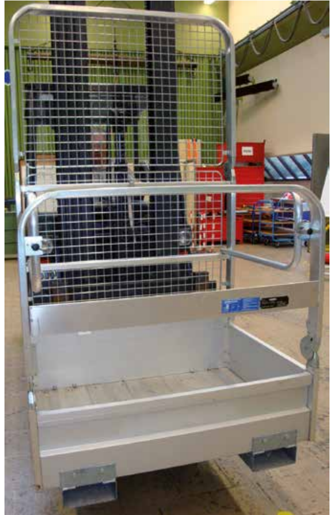
Bild 6-2: Beispiel einer Arbeitsbühne für Gabelstapler
