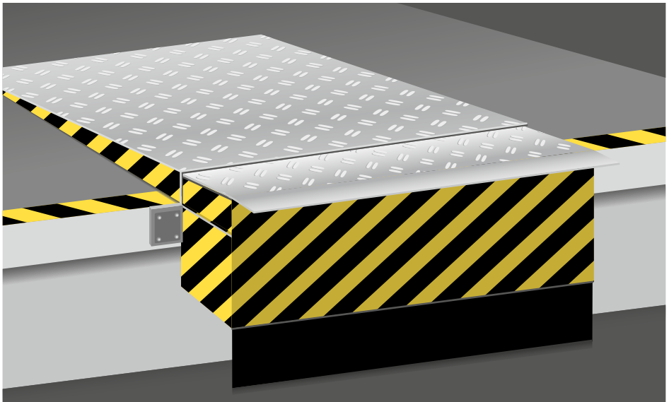
Abb. 5 Sicherung von Quetsch- und Scherstellen.
