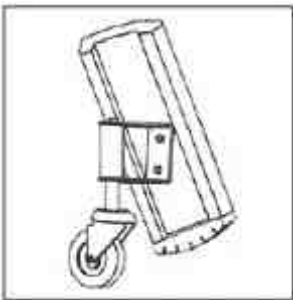
Bild 29: Federgelagerte Fahrrolle Automatische Sicherung durch die Belastung beim Betreten
