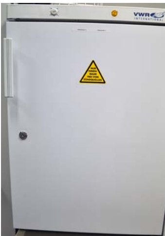
Abb. 20 und 20a Kühlschränke und Kühltruhen für das Aufbewahren entzündbarer Flüssigkeiten müssen mit dem Hinweis „Nur Innenraum frei von Zündquellen“ gekennzeichnet werden.
