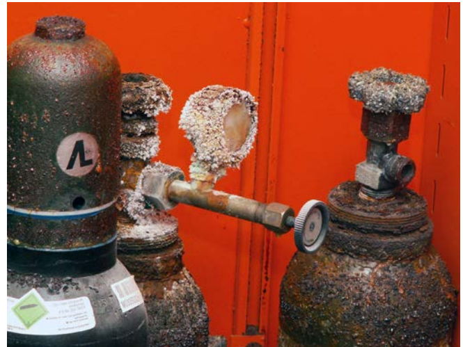
Abb. 23 Korrosionsschäden an Druckgasflaschen
