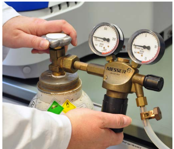
Abb. 27 Anschluss einer Gasflasche
