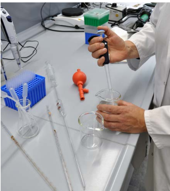
Abb. 39 Pipettieren mit Sicherheitspipette
