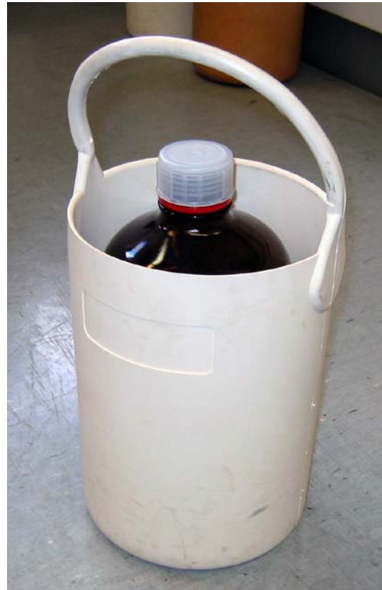
Abb. 38 Transport von Chemikalienbehältern
