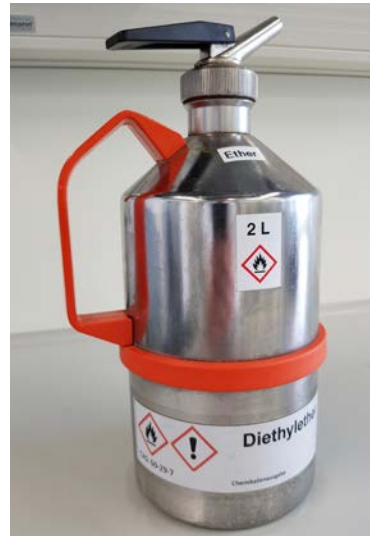
Abb. 44 Sicherheitsbehälter mit Flammenrückschlag- sperre und Druckent- lastung
