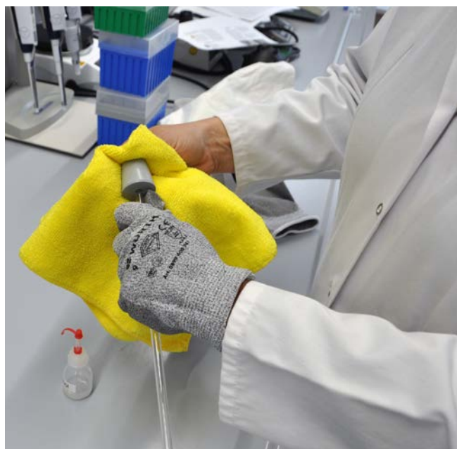
Abb. 8 Sicheres Durchführen eines Glasrohrs durch einen Stopfen
