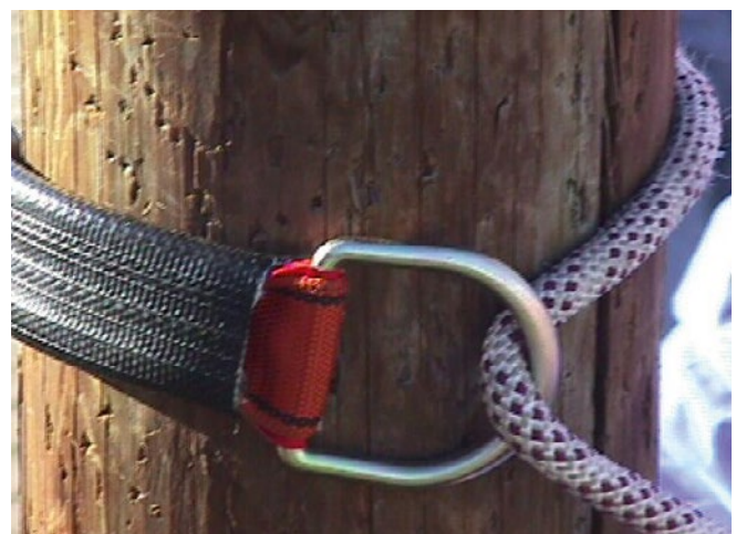
Abb. 7.8.1.2 Das Klemmseil/-band gewährleistet eine sichere Fixierung des Verbindungsmittels am Holzmast. Abrutschende Personen werden sicher gehalten.
