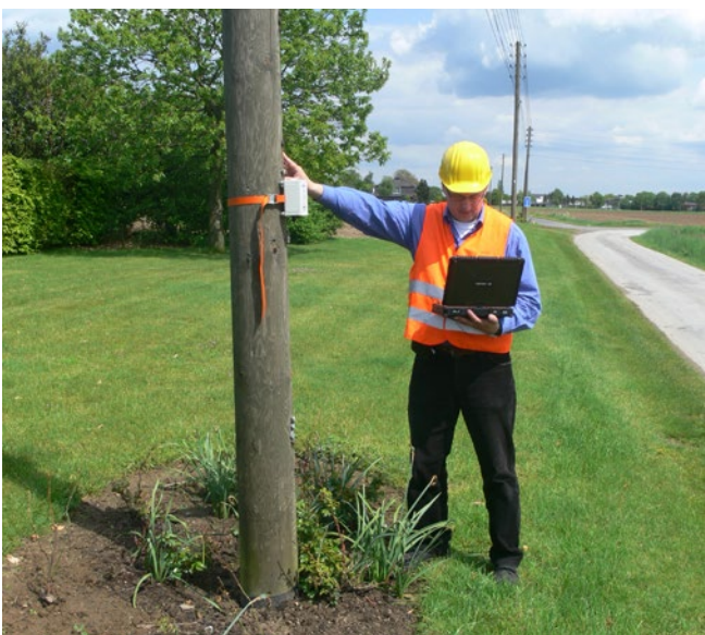
Abb. 7.4.5.3.c Schwingungsanregung des Mastes
