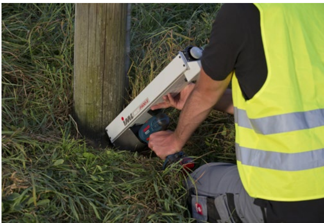
Abb. 7.4.5.2.a Der Materialzustand an einem Holzmast kann durch Messung des Bohrwiderstandes beurteilt werden. Dazu wird schräg unterhalb der Erdgleiche gebohrt.
