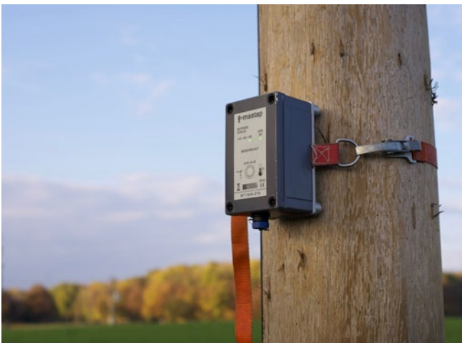
Abb. 7.4.5.3.a Befestigung des Messaufnehmers am Holzmast
