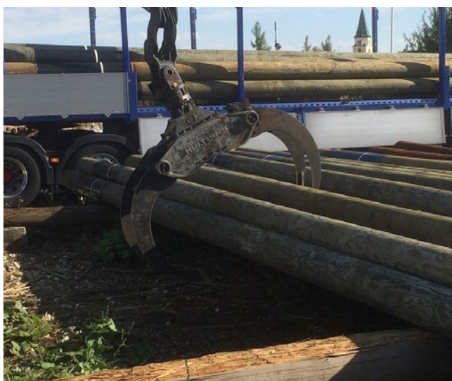
Abb. 4.1.4 Beispiel für eine hydraulische Greifzange als geeignetes Lastaufnahmemittel für Holzmaste
