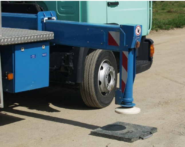
Abb. 4.1.5 Lkw-Stütze mit Unterlegplatte und Aufnahmevorrichtung am Lkw
