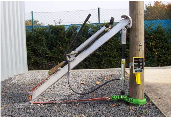
Abb. 7.4.5.4.a Der Mastbesteigesensor wird auf die Ursprungslage des Mastes kalibriert. Das Prüfgerät überträgt eine definierte Prüfkraft auf den Holzmast. Der Mastbesteigesensor sendet einen akustischen Alarm, wenn durch die Krafteinleitung eine unzulässige Neigung des Mastes eintritt. Bei fachgerechtem Einbau und ausreichendem Materialzustand des Mastes im Boden-Luft-Übergangsbereich kehrt der Mast nach Rücknahme der Prüfkraft in seine ursprüngliche Position zurück – der akustische Alarm endet.
