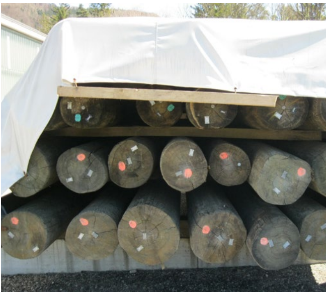
Abb. 3.1 Beispielhafte Lagerung von Holzlasten mit Abdeckung zum Schutz vor Witterungseinflüssen
