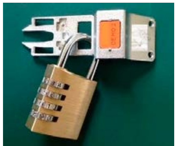
Abb. 30 Mögliche Sicherung eines Generalschlüssels (Steckschlüsselsystem)
