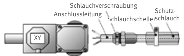
Abb. 28 Beispiel einer Schutzschlauchfixierung
