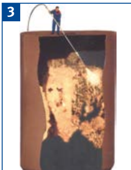
Beseitigen von Fließstörungen im Silo nach Möglichkeit von außerhalb beseitigen, nur im Notfall einfahren.
