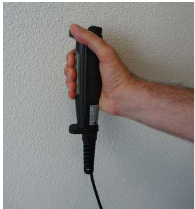
Abb. 6.16 Zustimmungsschalter für den Einricht-Betrieb mit 3 Stellungen (Aus-Ein-Aus) und zusätzlichem Start/Stopp-Schalter
