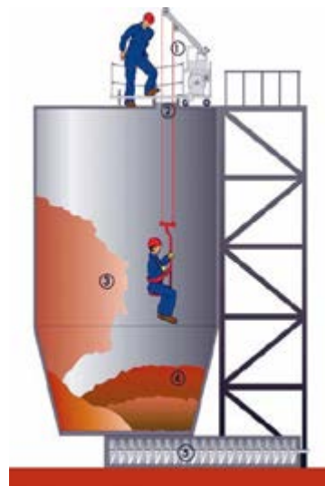
Abb. 7.14 Prinzip-Skizze zum Befahren eines Silos
