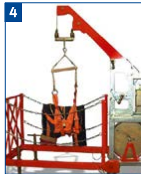
Einfahren mit Siloeinfahrvorrichtung.
