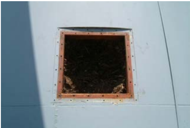
Abb. 8.9 Vorgefertigte Öffnung für den Einsatz eines Notentleerungssystems
