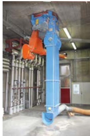
Abb. 7.10 Späneentnahme über Anschluss an gesonderten Entnahmestutzen
