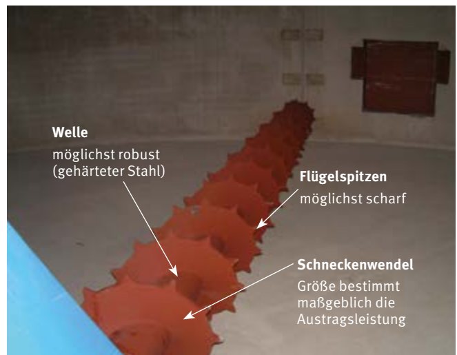
Abb. 6.10 Konstruktionsmerkmale einer Austragschnecke
