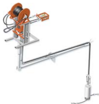
Abb. 8.4 Gelenkarm mit pneumatisch betriebenen Rotationsmotor
