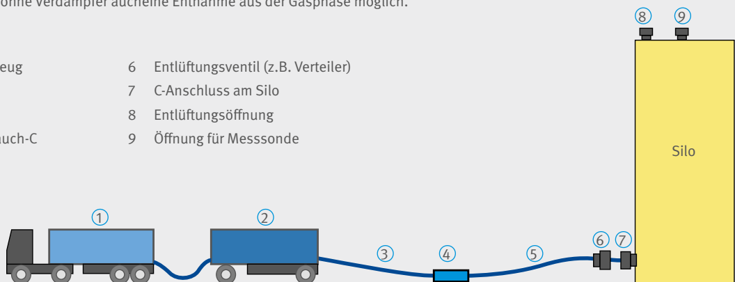
Abb. 9.7 Aufbauprinzip zur Stickstoff-Inertisierung bei Silobränden – Entnahme über Verdampfer aus der Flüssigphase –
