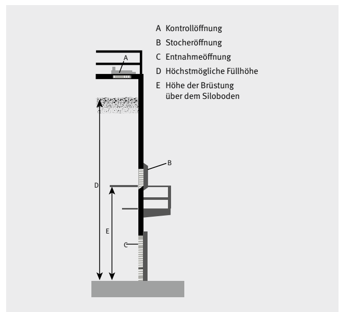
Abb. 5.4 Korrekte Anordnung der Entnahme- und Stocheröffnungen
