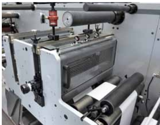
Schutzeinrichtungen an einer Stanzeinheit
