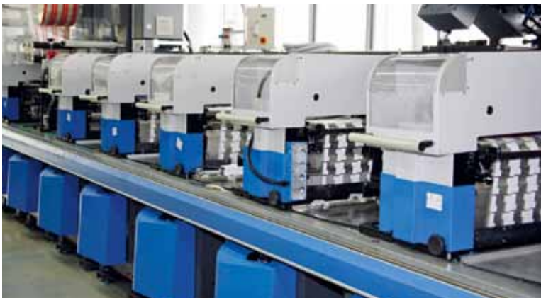
Trennende Schutzeinrichtungen an einer Etikettendruckmaschine
