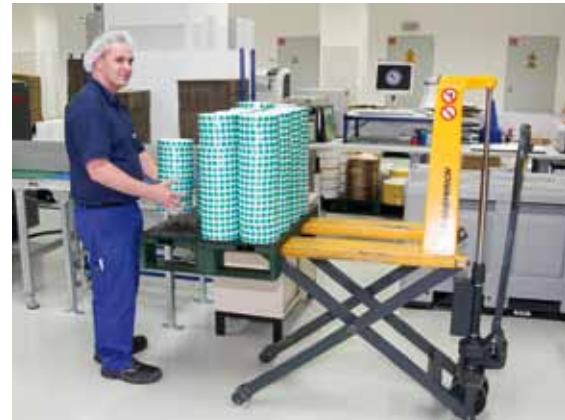
Einsatz eines Hubwagens zum Einstellen der ergonomisch günstigen Arbeitshöhe
