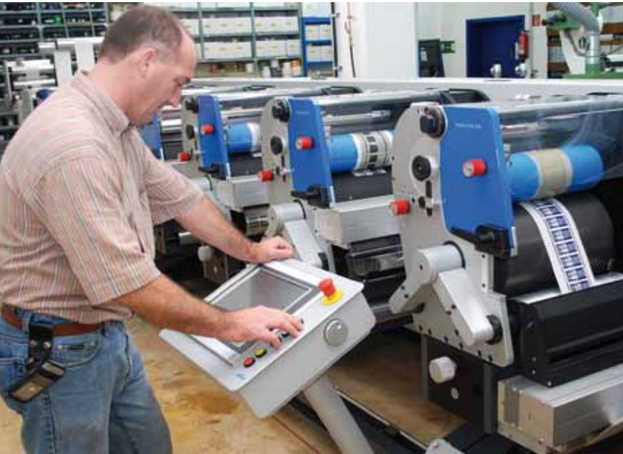
Günstig angeordnetes Bedienpult einer Etikettendruckmaschine
