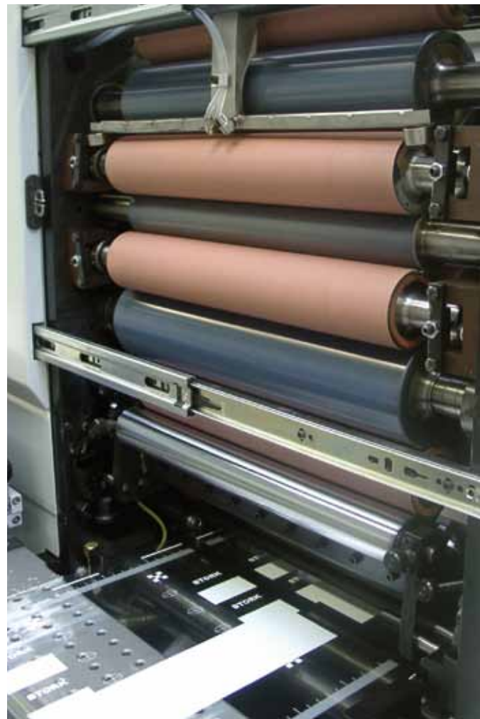
Druckwerk einer Etikettendruckmaschine mit integrierter Wascheinrichtung
