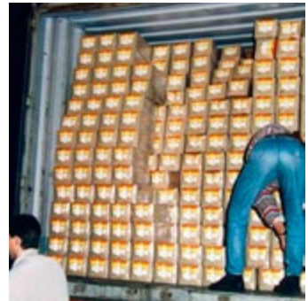
Abb. 6 Dichte Stauung ohne Freiraum – schwer zu lüften
