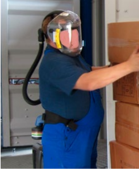
Abb. 11 und 12 Atemschutz mit Frischlufthaube mit Luftfilter bei der Entladung eines Frachtcontainers
