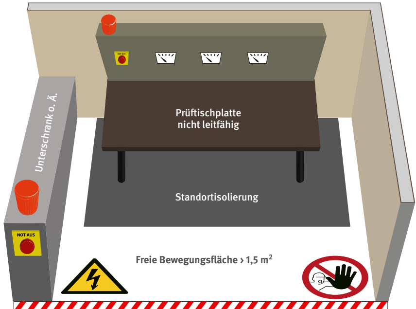
Abb. 6.1 Beispiel für einen Prüfplatz in einer Elektrowerkstatt.
