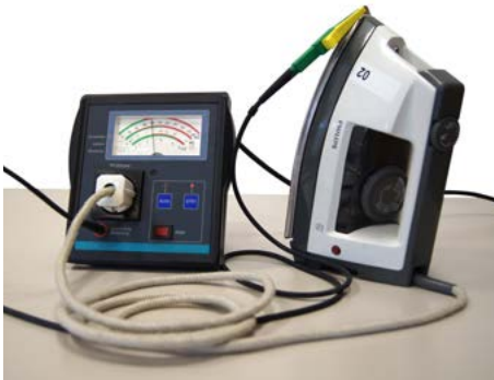
Abb. 5.8 Prüfgerät mit Analoganzeige und festgelegtem Prüfablauf für die Durchführung von Prüfungen nach VDE 0701-0702
