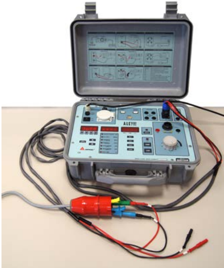
Abb. 5.6 Prüfgerät für die Geräte- und Maschinenprüfung gemäß VDE 0701-0702 und VDE 0113. Zusätzliche Eigenschaften (u. a.): Schutzleiterprüfung mit bis zu 25 A Prüfstrom, Hochspannungstest mit bis zu 5,1 kV, Restspannungsmessung, Netz-/Schleifenimpedanzmessung, Prüfung von Überstromschutzorganen und RCDS
