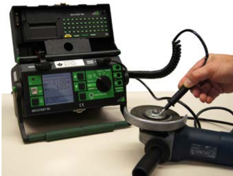
Abb. 5.4 Prüfgerät mit wahlweise manuellem oder automatischem Prüfablauf. Zusätzliche Eigenschaften; Protokolldrucker, Tastatur und Schnittstelle zur Nutzung von Barcodescannern in Verbindung mit einer Protokollierungs- bzw. Prüf- und Protokollierungssoftware
