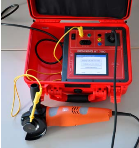
Abb. 5.2 Staub- und feuchtigkeitsgeschütztes Prüfgerät im Hartschalenkoffer. Zusätzliche Eigenschaften: SD-Kartenleser, Touchscreen, Auswahlmöglichkeit für manuelle und automatische Prüfsequenzen
