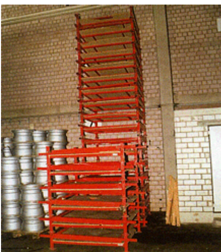
Bild 6-7: Lagerung leerer Stapelgestelle
