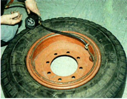
Bild 2-6: Befüllung mit zu kurzem Befüllschlauch, dadurch zwangsläufig Aufenthalt im Gefährdungsbereich!
