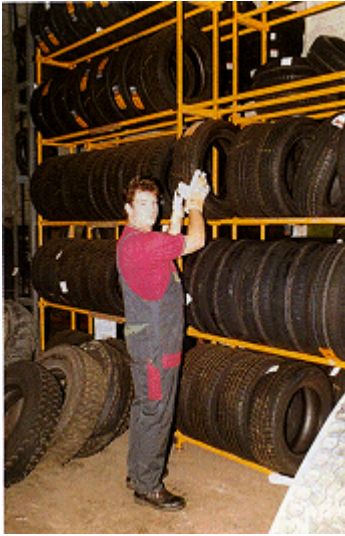
Bild 6-8: Stehende Lagerung von Reifen
