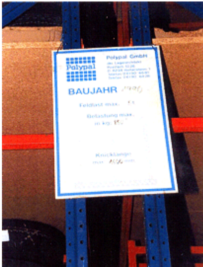
Bild 6-10: Regal mit Angabe der zulässigen Fach- und Feldlasten
