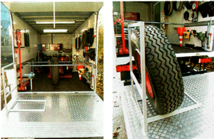
Bild 3-2 und 3-3: Sicherer Radtransport mit der Hubladebühne (Quelle: Tip Top Stahlgruber)
