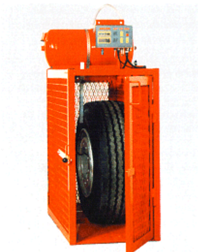
Bild 2-11: Großreifenbefülleinrichtung mit Befüllcomputer
