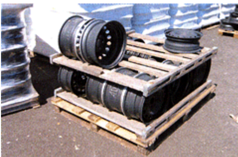
Bild 6-4: Stapelhilfsmittel zur senkrechten Lagerung von Felgen
