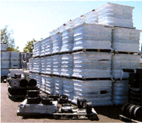
Bild 6-5: Blocklagerung von Rädern im Freien
