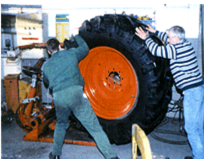
Bild 2-4: Positionieren eines Schlepperrades – Aufnahme durch die Reifenmontiermaschine
