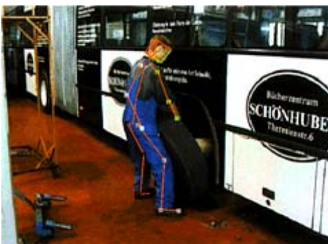
Bild 4-11: Wirbelsäulenbelastung: Last 80 kg, Kraft 8723 N
