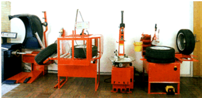
Bild 2-2: Reifenmontagesystem mit integrierter computerunterstützter Befülleinrichtung
