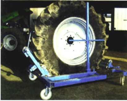
Bild 2-5: Transporteinrichtung für Großräder mit integrierter Raddrehrichtung
