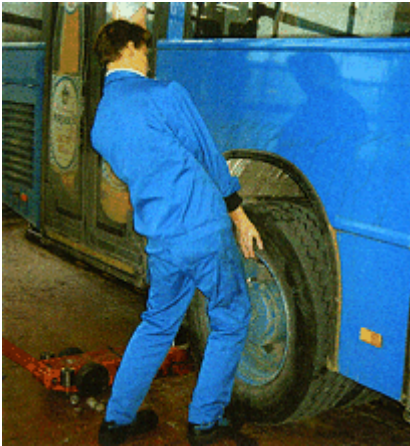
Bild 4-4: Lkw-Radmontage ohne Montagehilfe
