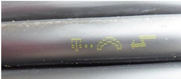
Abb. 1 Telekommunikationsleitung mit Blitzsymbol
