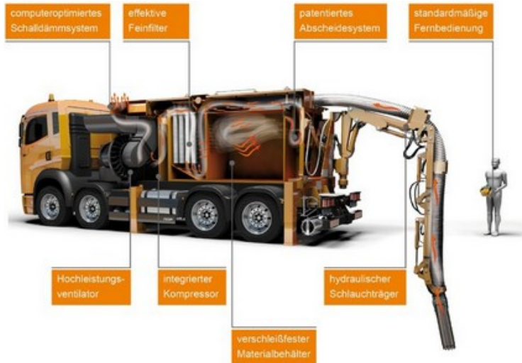
Abb. 10 Bestandteile eines Saugbaggers
