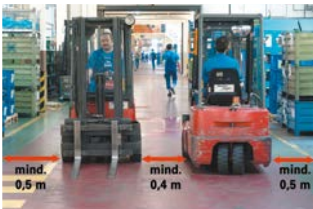
Bild 6-4: Der Sicherheitsabstand zwischen Gabelstapler und Grenze des Verkehrsweges muss mindestens 0,5 m betragen, zwischen den Gabelstaplern mindestens 0,4 m
