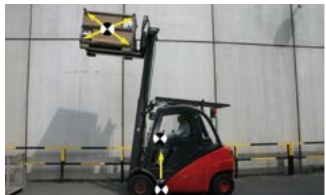
Bild 6-22: Verlagerung des Gesamtschwerpunktes bei angehobener Last
