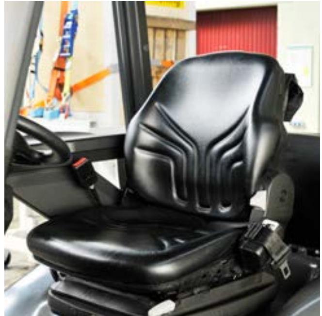
Bild 2-6: Schalensitz mit Beckengurt
