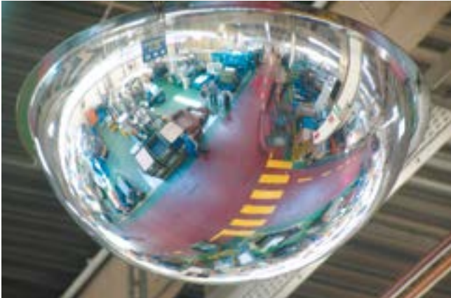
Bild 6-3: Kugelspiegel an unübersichtlicher Stelle
