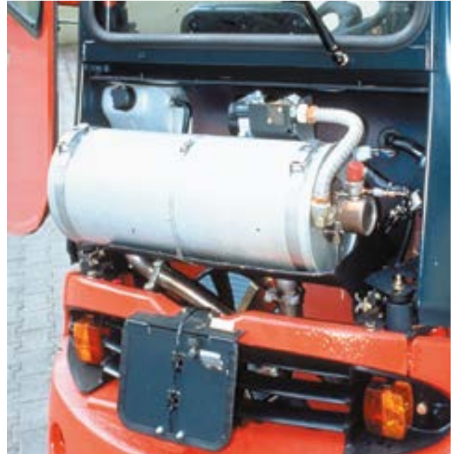
Bild 3-1: Gabelstapler mit Rußfilter und integrierter Regenerations-einrichtung
