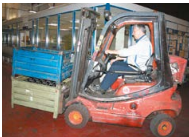
Bild 6-14: Nach hinten geneigter Hubmast
