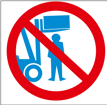
Bild 2-3: Anschlag „Aufenthalt unter der Last verboten“
