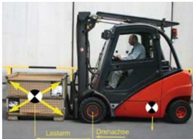
Bild 6-8: Schwerpunkte des Gabelstaplers und der Last
