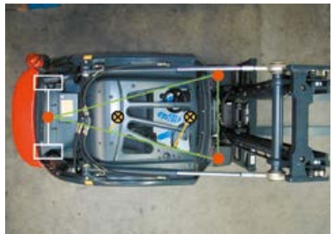
Bild 6-25: Kippkanten-Dreieck mit Hebelarmen – senkrechter Abstand Schwerpunktlage bis Kippkante – des leeren und beladenen Gabelstaplers
