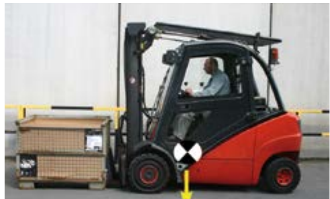
Bild 6-21: ... ergeben den Gesamtschwerpunkt bei abgesenkter Last
