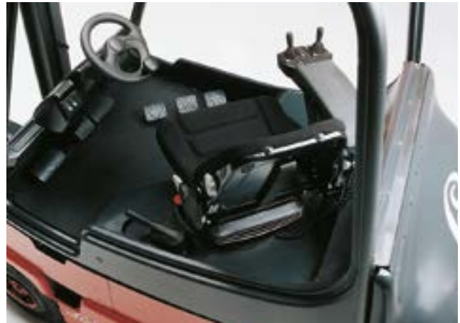
Bild 6-18: Drehbarer Fahrersitz – System „Linde“
