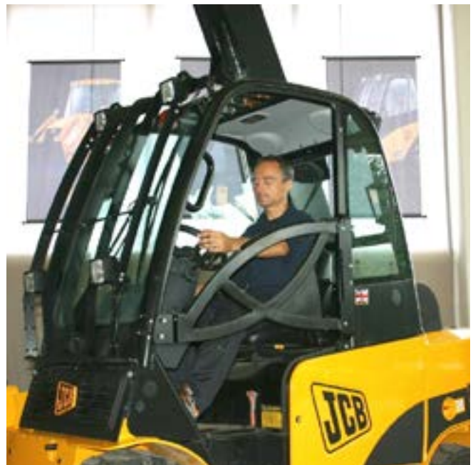
Bild 2-7: Bügeltüren als Rückhalteeinrichtung.
