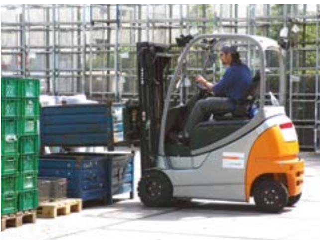
Bild 2-4: Gabelstapler mit Fahrerschutzdach
