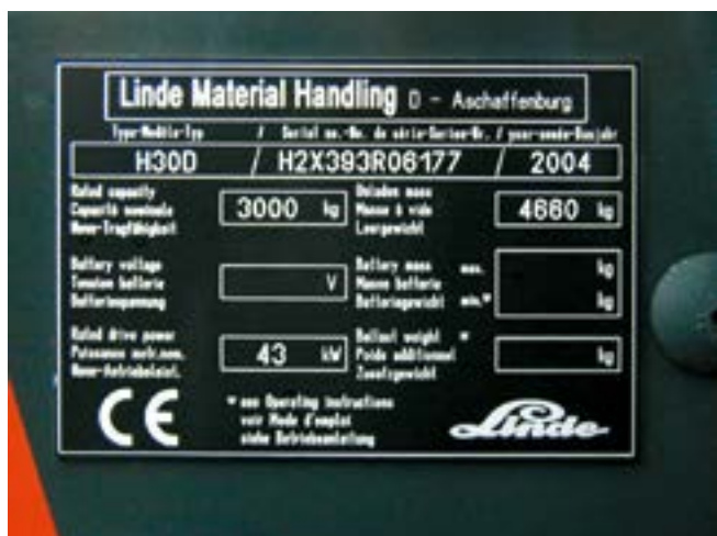
Bild 2-1: Fabrikschild mit CE-Zeichen für ein Flurförderzeug
