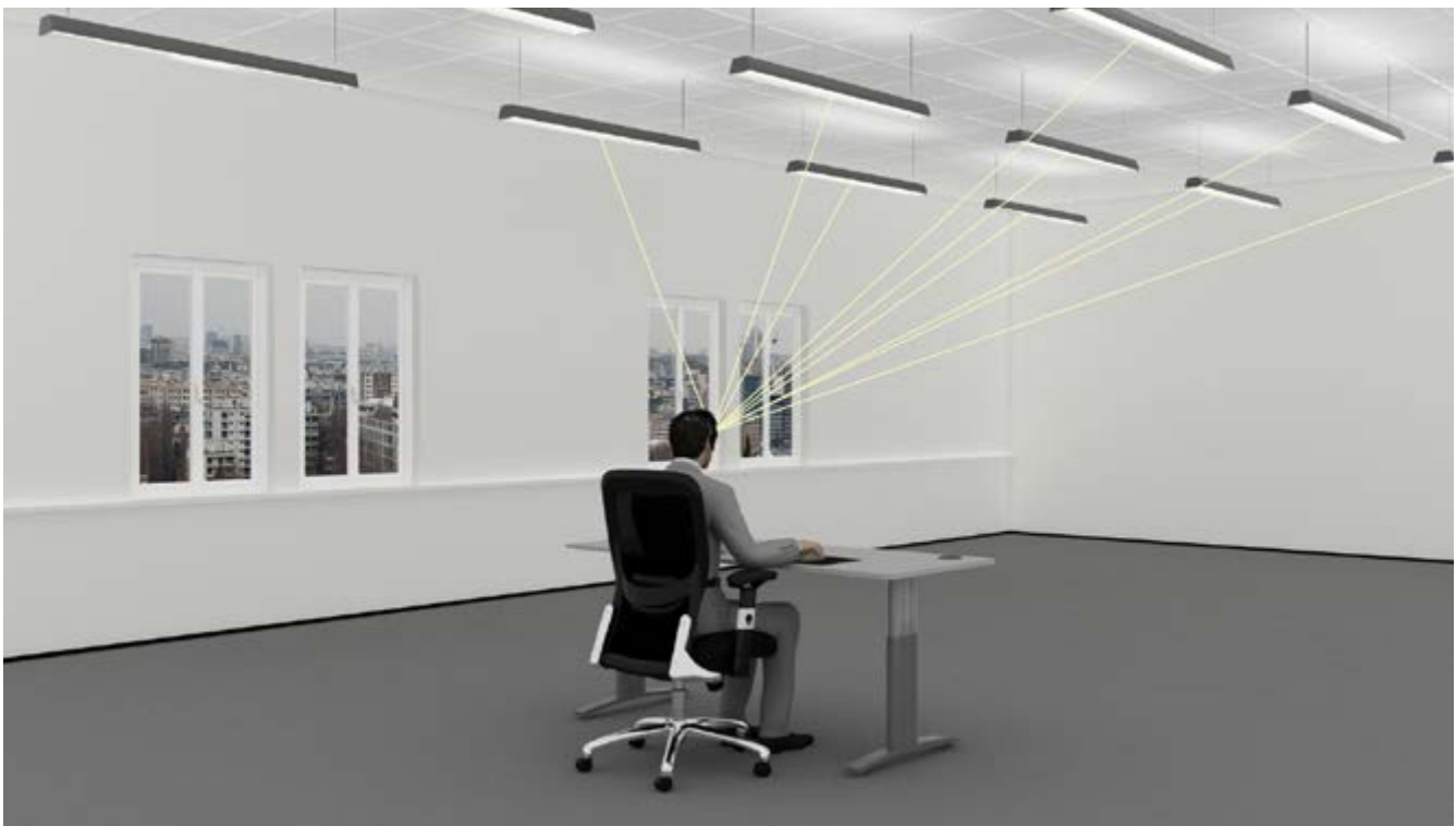
Abb. 35 Das UGR-Verfahren berücksichtigt alle Leuchten im Raum, die zu einem Blendeindruck beitragen, sowie die Helligkeit von Wänden und Decken, um einen UGR-Wert zu ermitteln.
