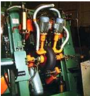
Abbildung 40: Reifenrunderneuerung (Schutzeinrichtung entfernt)
