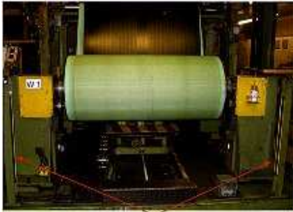
Abbildung 26: Absicherung einer Wickelstelle mit Lichtschranke
