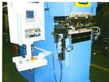
Abbildung 35: Zweihandsteuerung an einer Spritzgießmaschine
