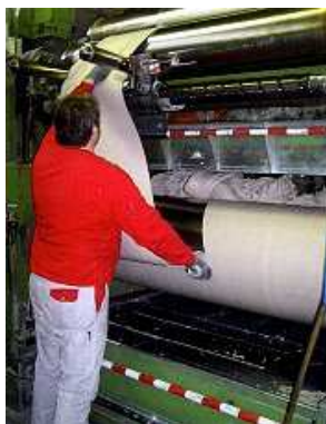
Abbildung 18: Ausschneiden der Mischung auf einer mit Schaltstange gesicherten Walze
