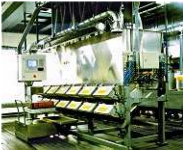
Abbildung 11: Anlage zum Abwiegen von Einsatzstoffen
