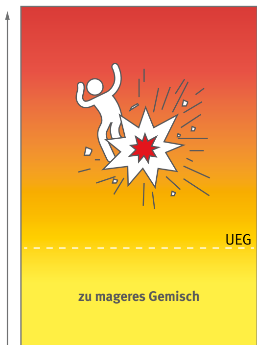
Abb. 3 Zusammenhang Dampfdruck und Explosionsgrenzen bei Gasen und Dämpfen
