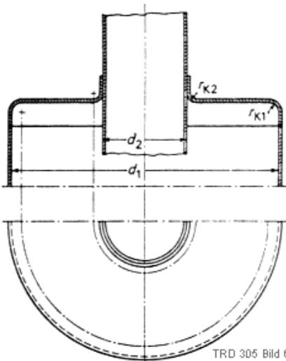
**Bild 7.** Lichte Weite einer rechteckigen oder elliptischen Platte
