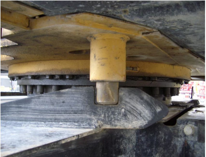
Abb. 40 Dreh Sperre an einem Hydraulikbagger in Sperrstellung
