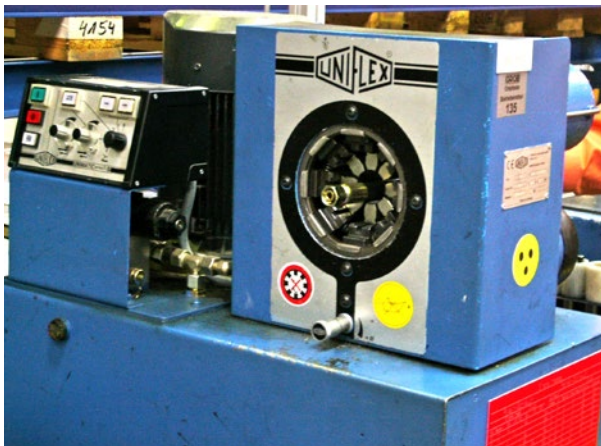
Abb. 14 Vorrichtung zum Verpressen von Schlaucharmaturen
