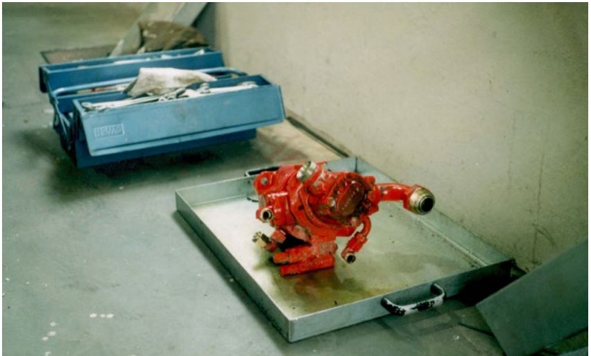
Abb. 19 Mobilhydraulikpumpe in einer Ölauffangwanne
