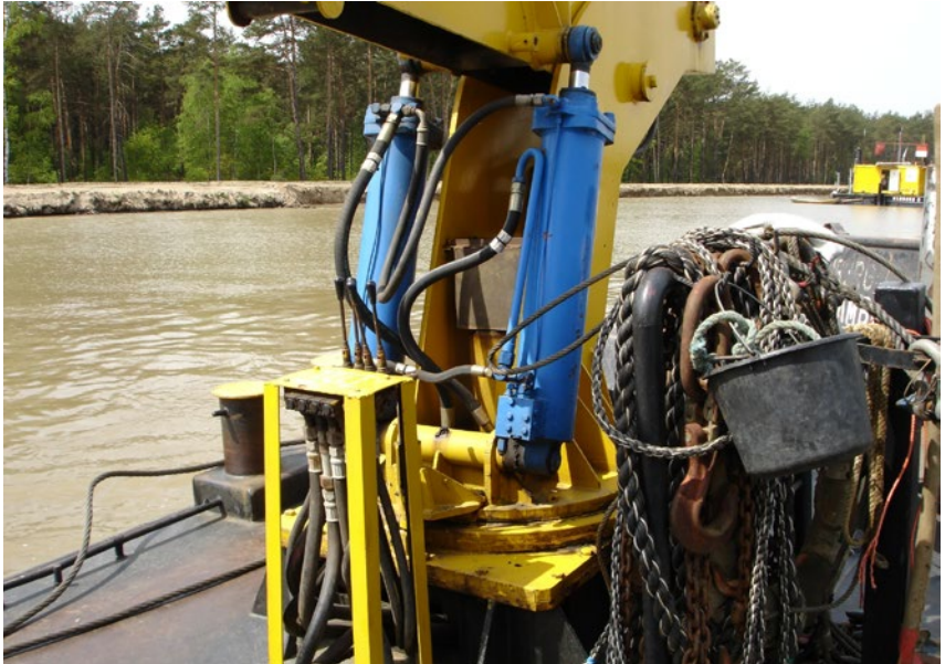
Abb. 42 Bordkran auf einem Schubboot
