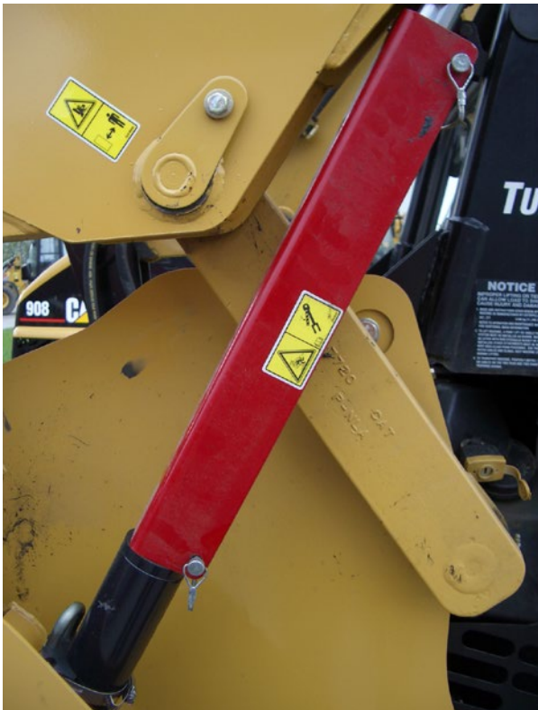
Abb. 41 Stützeinrichtung in Position an einer Erdbaumaschine
