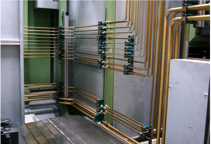
Abb. 10 Fachgerechte Befestigung von Rohrleitungen mit Leitungshalterungen
