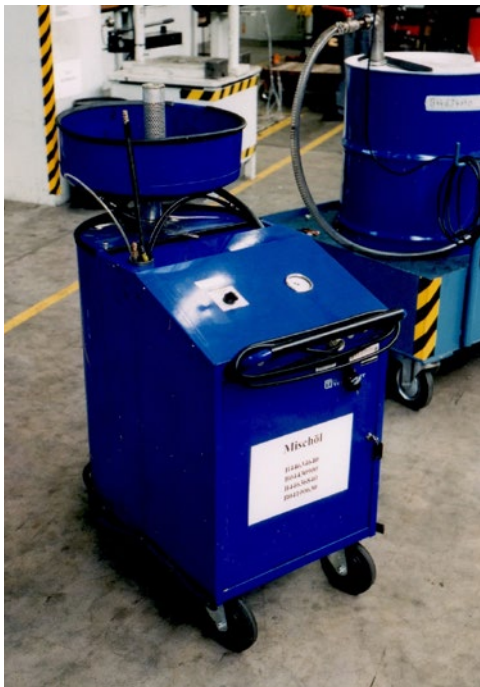
Abb. 34 Hilfsgerät zur Entsorgung von alter Druckflüssigkeit
