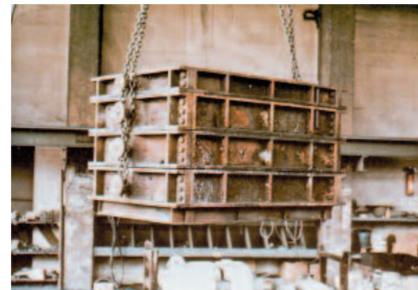
Bild 5-1: Transport eines Formkastenstapels
