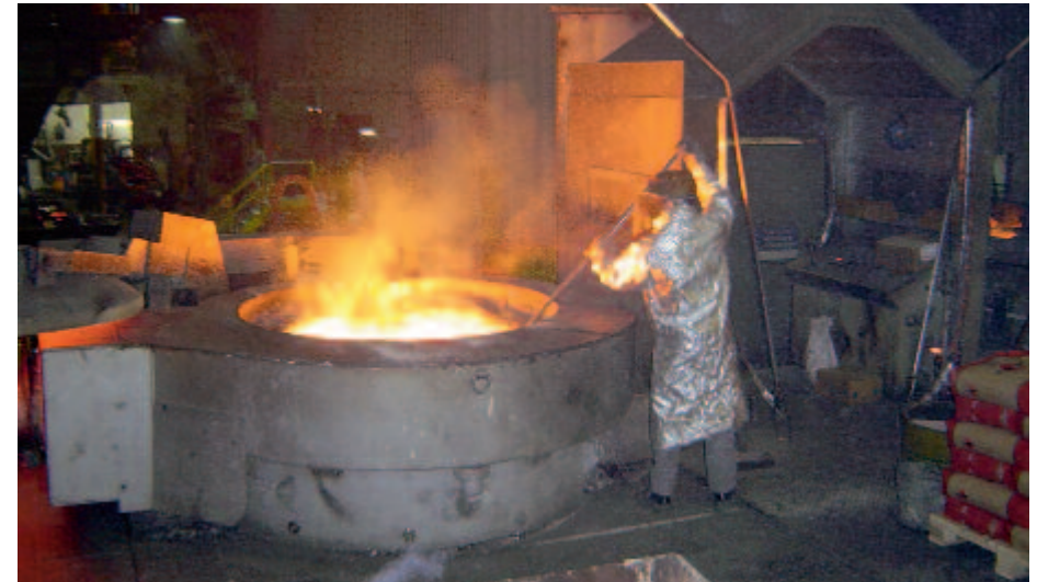
Bild 2-2: Probenahme am Induktionsofen
