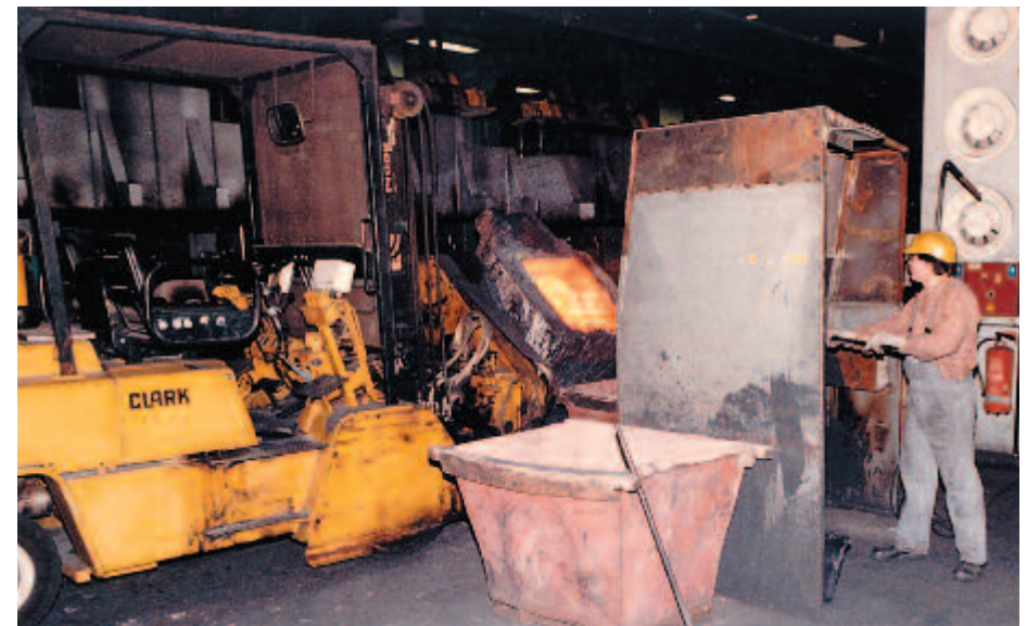
Bild 7-3: Flüssigeisentransport mit dem Gabelstapler
