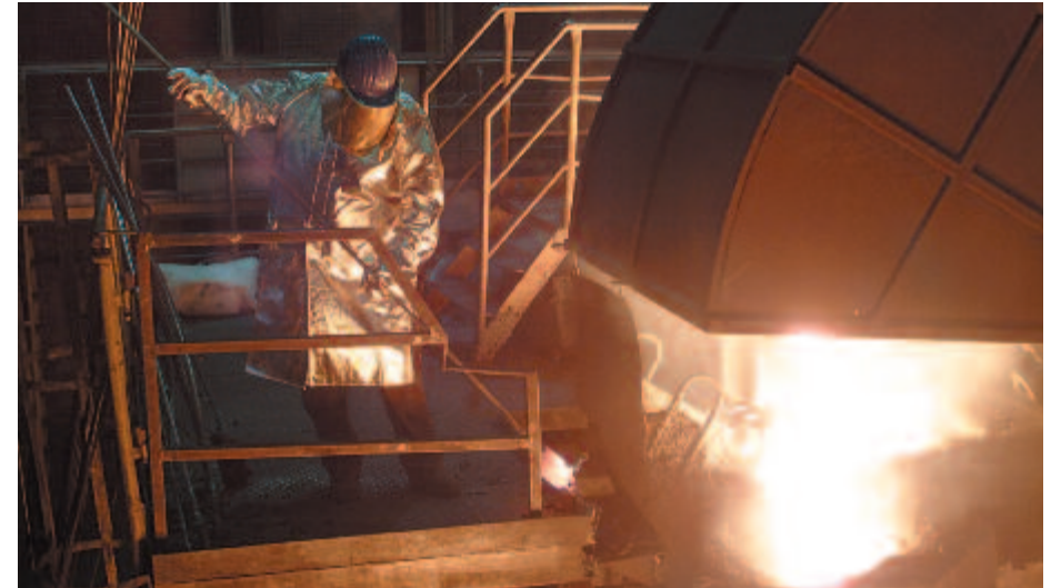
Bild 12-2: Körperschutz bei Arbeiten an der Kupolofenrinne
