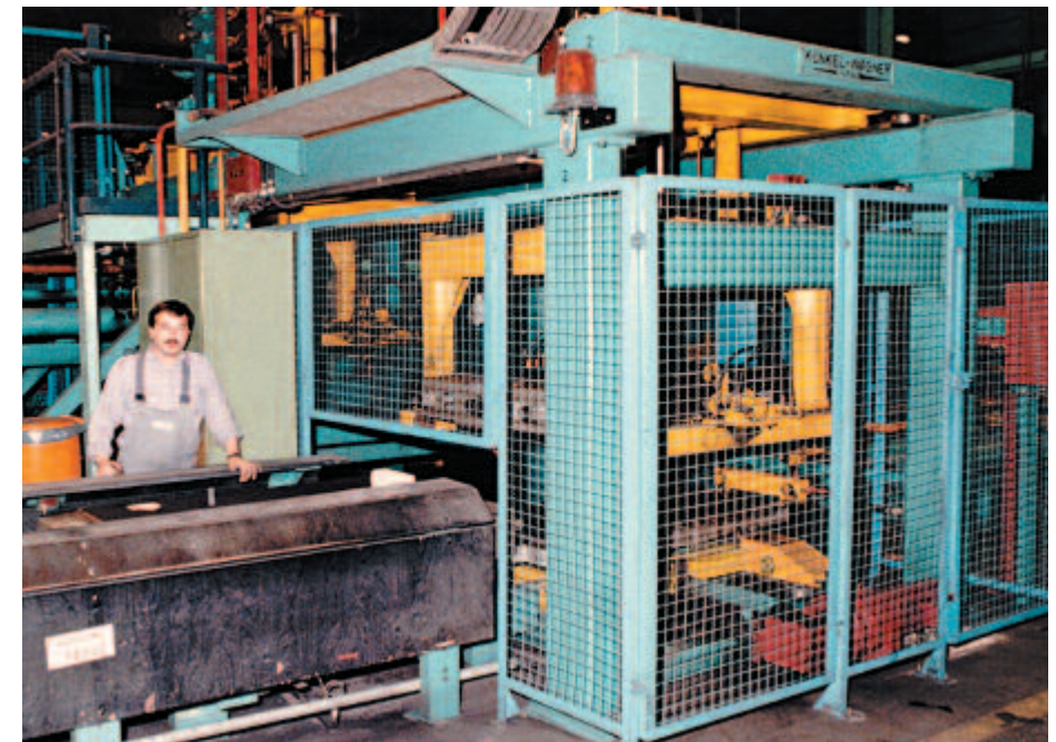
Bild 4-2: Absicherung einer Formanlage
