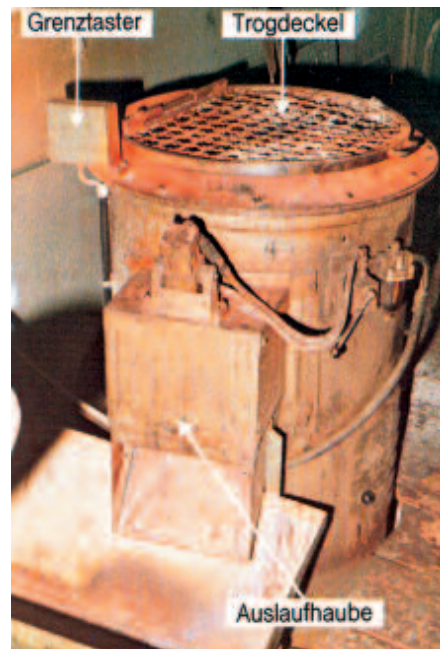
Bild 3-3: Kernsandmischer mit Absicherung der Gefahrenstellen
