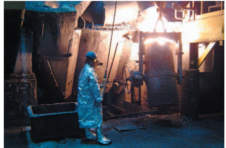
Bild 7-1: Abfüllen einer Transportpfanne
