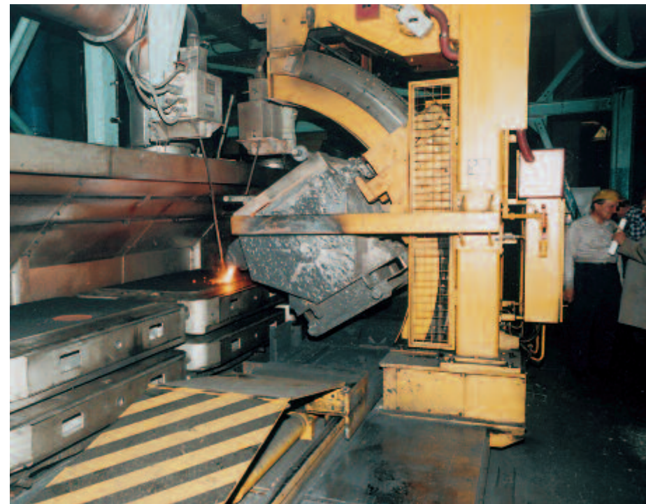
Bild 1: Gießbahn einer Formanlage
