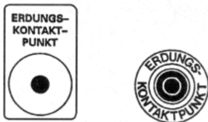
Abb. 4 Beispiele für Kennzeichnung des Erdungskontaktpunktes
