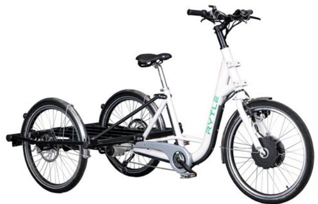
Abb. 7 Zweispurig, Laufradpaar hinten
