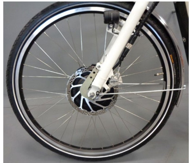
Abb. 23 Nabenmotor im Vorderrad
