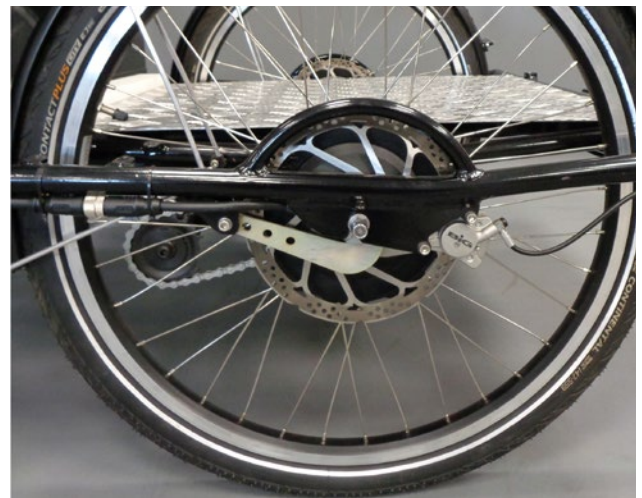
Abb. 25 Nabenmotor im Hinterrad
